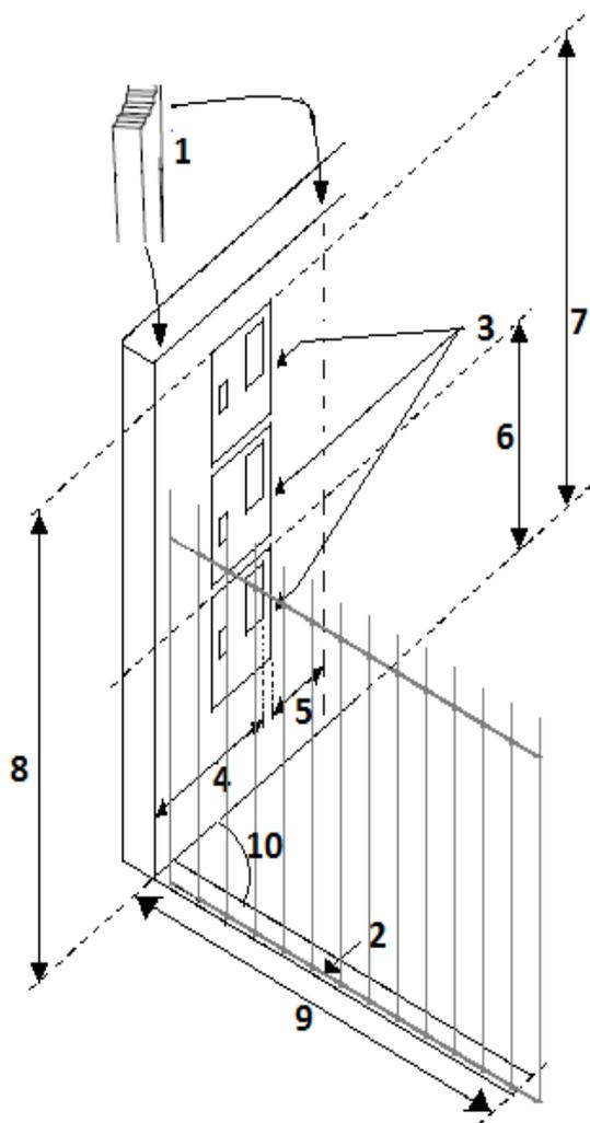
1 - O Poste poderá ser instalado antes ou após a caixa de medição, desde que o ramal de ligação não transponha o terreno vizinho.
