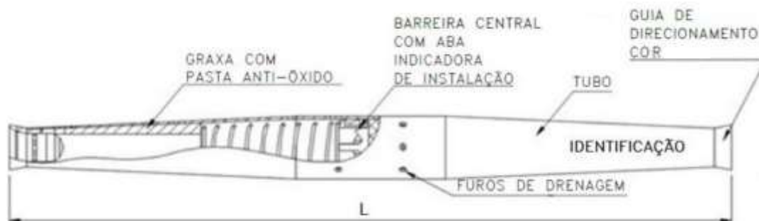
Figura 1 – Luva de emenda automática para cabo de alumínio
