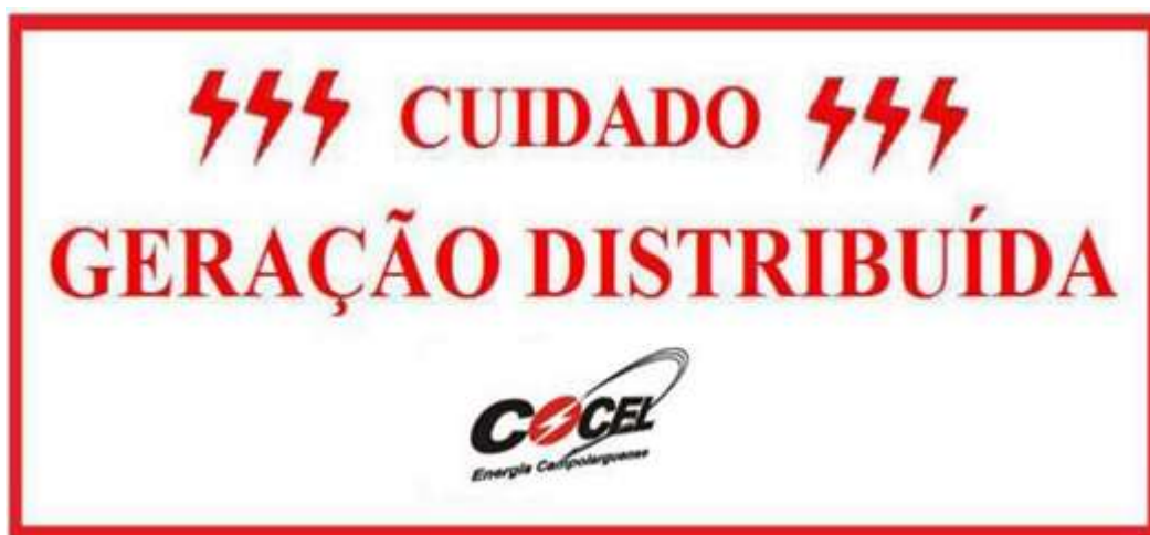
Figura 6.16 - A placa de advertência deverá ser confeccionada com espessura mínima de 1 (um) mm, dimensões 25x18 cm, fundo na cor BRANCA e palavras em VERMELHO, com o logotipo da COCEL.
