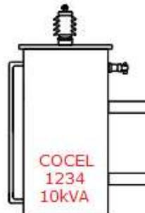
FIGURA 7 – Formato da identificação dos transformadores
